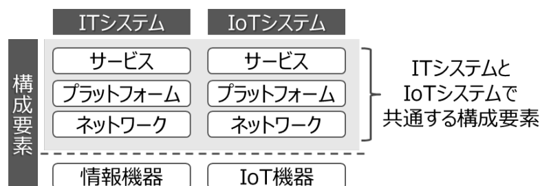
図2 ITシステムとIoTシステムの構成要素の対比
