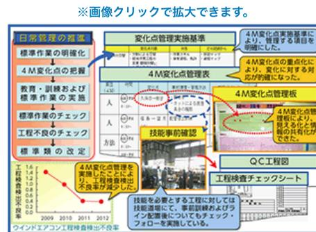
図8 4M変化点管理による工程管理の強化
