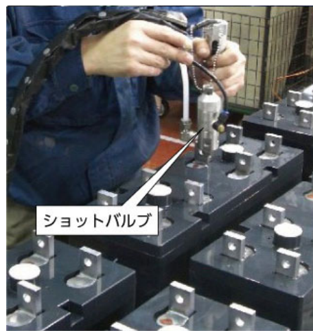
(写真2) 改善後の樹脂封口工程
