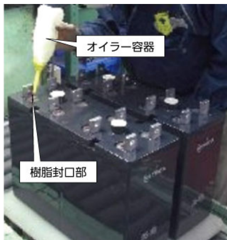
(写真1) 改善前の樹脂封口工程
